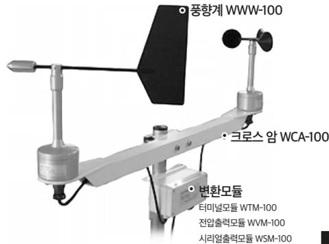
그림 1 전형적인 풍향풍속계의 설치 상태
